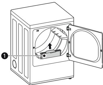
Assurez-vous que le filtre à charpie soit toujours correctement installé avant de démarrer la sècheuse. Un fonctionnement de la sècheuse avec un filtre mal fixé ou manquant risquerait d'endommager la sècheuse et les articles dans la sècheuse.
