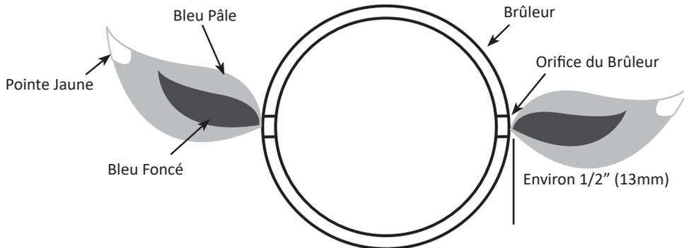
**Ajustement De L'air De Combustion (ceci doit être effectué par un installateur qualifié):** Le volet d'air est réglé à l'usine et ne devrait pas avoir besoin normalement d'être ajusté. Cependant dans des conditions exceptionnelles un ajustement peut être requis. Lorsque le volet d'air est bien ajusté, les flammes seront bleues foncées avec des pointes bleues pâles ou quelques fois jaunes.
