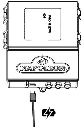
Alternativement, l'appareil peut être alimenté en utilisant une alimentation directe via le port USB de type C. Pour ce faire, utilisez un adaptateur 5V 1A. Il est recommandé de retirer les piles si vous utilisez une alimentation directe pour éviter la corrosion et prolonger la durée de vie des piles.
