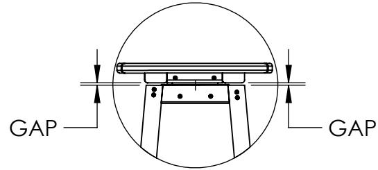
NOTE: THE TOP STRINGER SHOULD BE FLUSH AGAINST THE LIP ON THE SWIVEL MECHANISM AND EVEN ON ALL SIDES.
