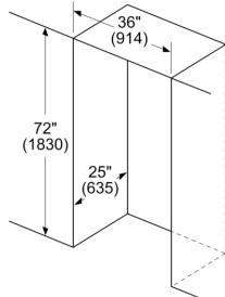
Laissez un espace de  $\frac{1}{2}$  pouce (12,7 mm) au-dessus et 1 pouce (25,4 mm) derrière le réfrigérateur pour une ventilation correcte. Il est recommandé de ne pas installer le réfrigérateur près d'une source de chaleur, comme un four ou une cuisinière.
