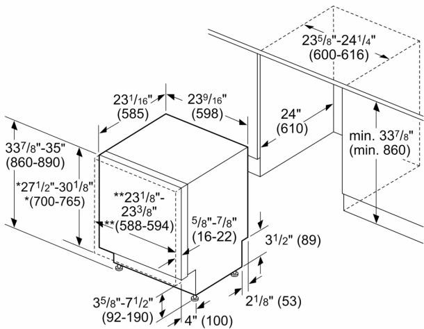
\* Mesuré depuis le bord inférieur du plan de travail, épaisseur recommandée du panneau  $3/4"$  (20 mm), poids du panneau 7-22 lbs (3-10 kg)
