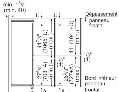
Les dimensions de porte de meuble indiquées sont valables pour un joint de porte de  $1/8''$  (4 mm). Mesures en mm
