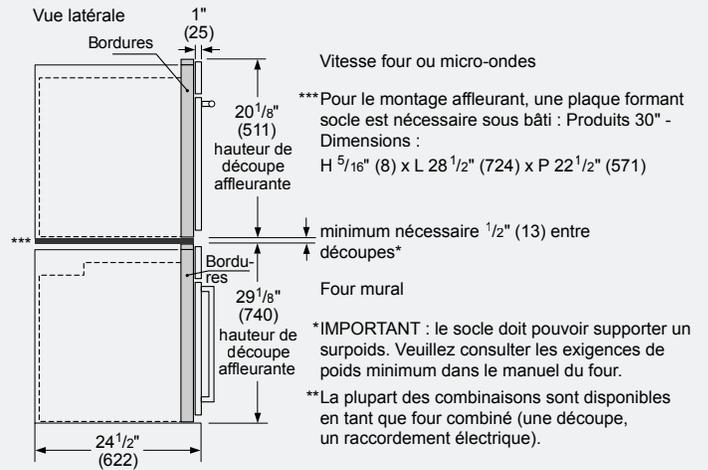
\*\*\*Pour le montage affleurant, une plaque formant socle est nécessaire sous bâti : Produits 30" - Dimensions : H 5/16" (8) x L 28 1/2" (724) x P 22 1/2" (571)
