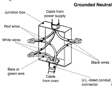
Consulter la Figure A, où les codes locaux permettent la connexion du fil de MISE À LA TERRE du four au fil NEUTRE du circuit de dérivation (fil gris ou blanc) :
