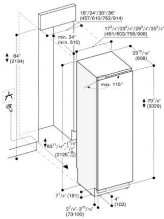
Les dimensions maximales de l'avant de la porte sont basées sur un écart de 2mm.
