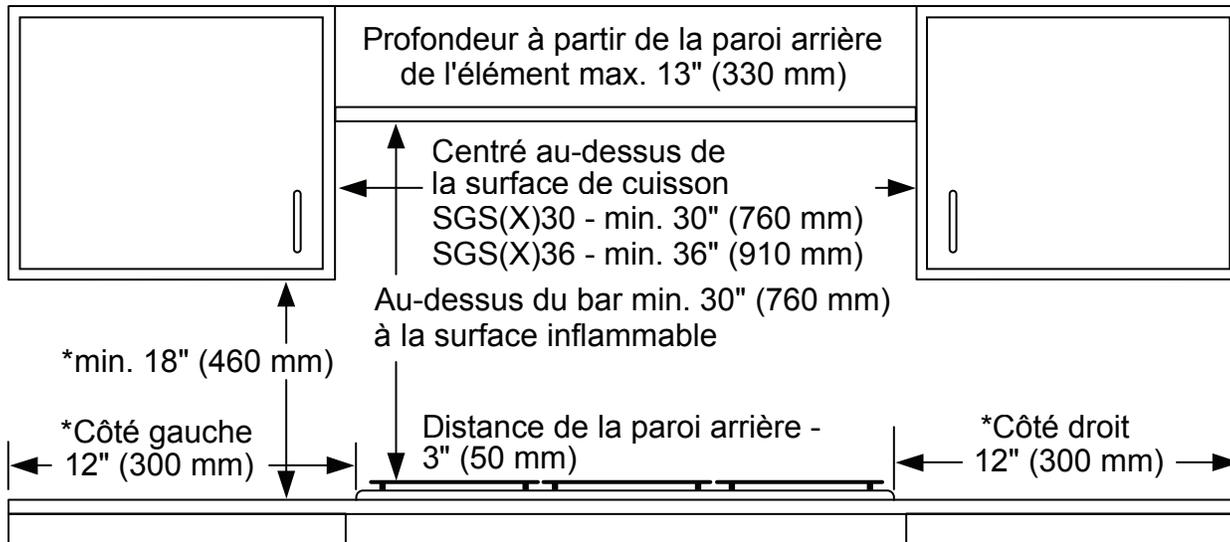
\* La dimension de distance de la paroi latérale peut être réduite à 5" (127 mm) si la paroi latérale contiguë est  $\geq 23"$  (584,2 mm)
