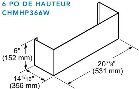
Couvre-conduit standard pour des hauteurs de plafonds allant jusqu'à 8 pi
