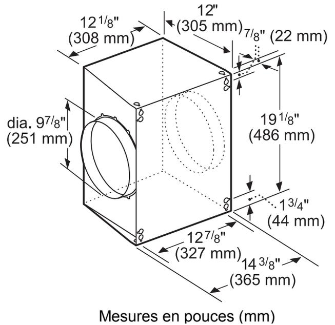
**VENTILATEURS INTÉGRÉS (MONTÉS À L'INTÉRIEUR DE LA HOTTE)**
