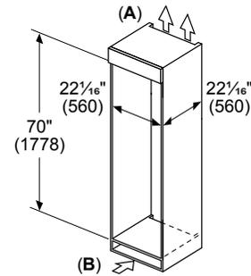
**A:** Sortie d'air  $\geq 31''^2$  ( $\geq 200 \text{ cm}^2$ )
